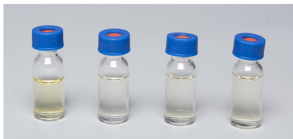
图 1 不同品牌多功能净化柱处理样品后的脱色效果图 (①玉米粉提取液-未净化处理 ② Copure®224-净化处理 ③ 国外 A 品牌-净化处理 ④ 国内 B 品牌-净化处理)
